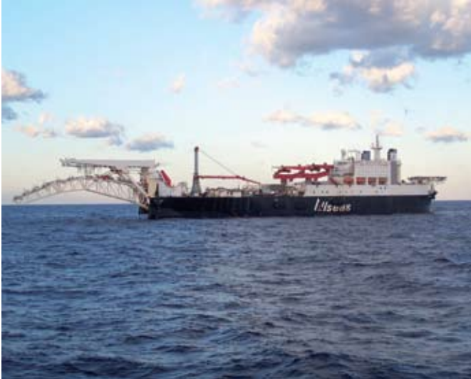
Suomenlahden reittiosuus rakennetaan pääasiassa kuvan "Solitaire"-aluksella. Turva-alue aluksen ympärillä on 2 km.
