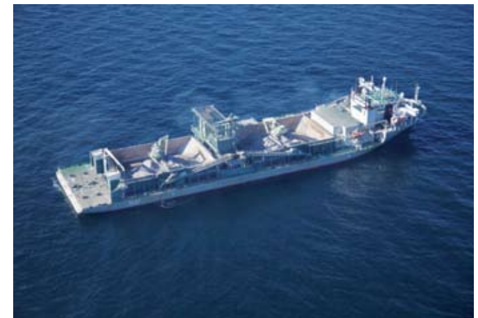
Kiviaineksen sijoitukseen käytettävä Seahorse-alus.
